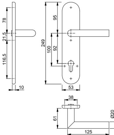
Diese Halbgarnitur bietet die Möglichkeit einer durchgehenden Verschraubung mit einer Schutz-Schlüsselrosette (ab S. 282) auf der Türaußenseite.
