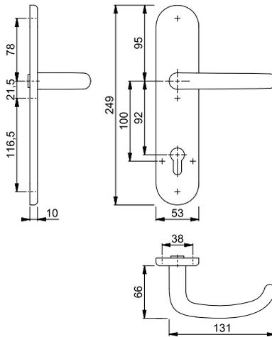
Diese Halbgarnitur bietet die Möglichkeit einer durchgehenden Verschraubung mit einer Schutz-Schlüsselrosette (ab S. 282) auf der Türaußenseite.
