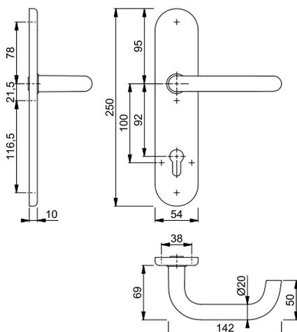
Diese Halbgarnitur bietet die Möglichkeit einer durchgehenden Verschraubung mit einer Schutz-Schlüsselrosette (ab S. 282) auf der Türaußenseite.
