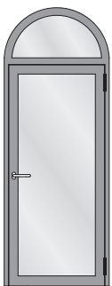
Einflügelige Türe mit Rundbogen-Oberlicht Porte à un vantail avec imposte demi-ronde Single leaf door with round arched top light
